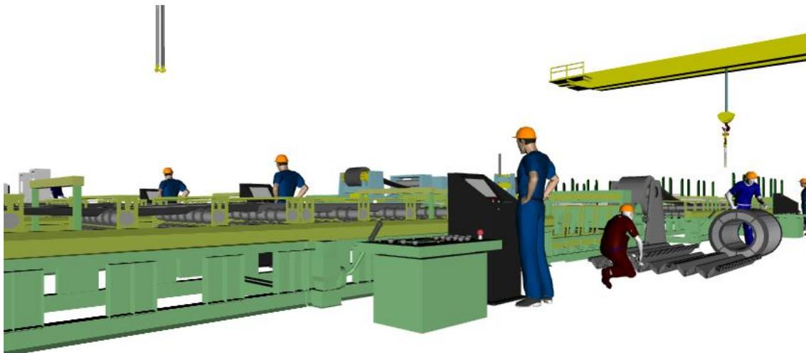
Цикл учета начинается с отпуска штрипса на стан. Оператор стана, перед тем как установить штрипс на разматыватель отрывает нижнюю часть купонной этикетки и считывает штрих-код с помощью встроенного сканера стационарного терминала. Стационарный терминал идентифицирует по штрих-коду типоразмеры установленного штрипса, сверяет его с заданием и передает в бизнес-приложение информацию об отпуске материала в производственный наряд-заказ.
