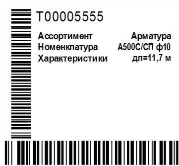
*Технологическая бирка на открытом складе с указанием типоразмеров номенклатуры*
